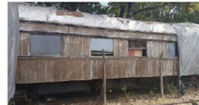
Estado del coche en 2017 aún con remanentes de lona y con ventanas rotas por donde sacaron el mobiliario.
