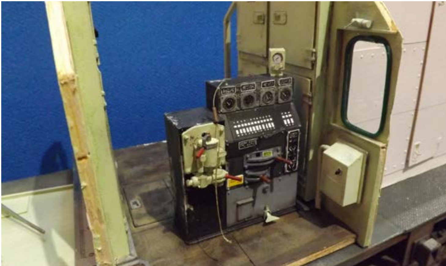
El pupitre de comandos está listo para sacarla en marcha, pero hay faltantes en la carrocería.
