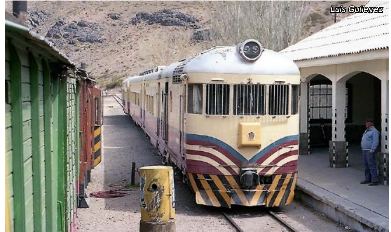
Hasta la estación Polvaredas la tracción era por adhesión, comenzando en breve el sector a cremallera.
