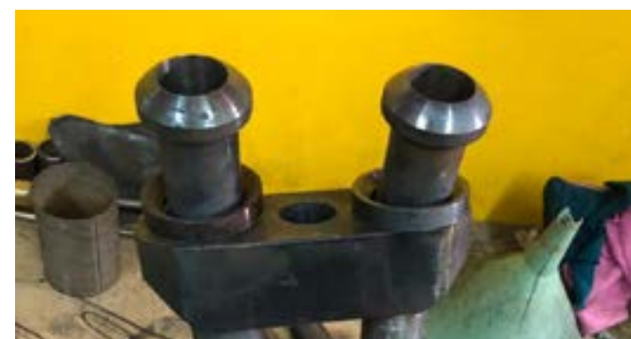
Fabricación artesanal y precisa de los tubos recalentadores para la Baldwin 19.
