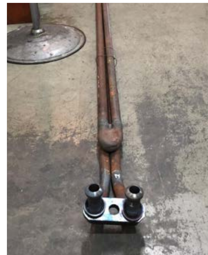
Fabricación artesanal y precisa de los tubos recalentadores para la Baldwin 19.
